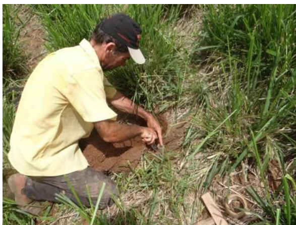
Retirada de amostras de solo, para avaliação físico – hídrica do solo, no município de Inhapim - MG
